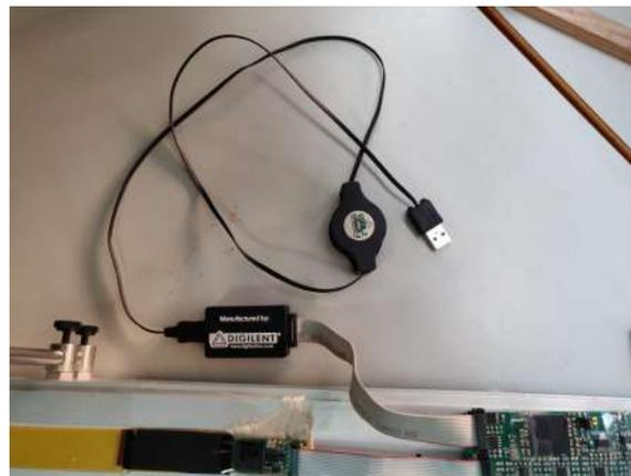
Figura 1.10: Programador convertidor de USB a JTAG.
