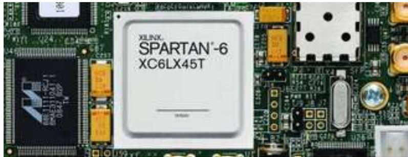
Figura 2: Modelo de FPGA usada en el proyecto. Xiling Spartan 6.<sup>2</sup>
