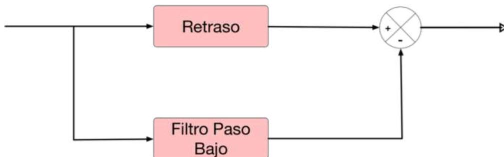
Figura 3.3: Diagrama que muestra el uso de un filtro paso de bajo para eliminar la componente DC.
