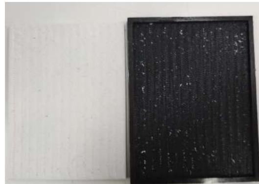
(b) Rugosidad del molde aplicada en la lámina.
